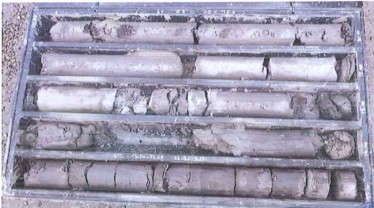
Sondaggio S1 – Cassetta C3 – da 10,00 a 15,00 m di profondità dal p.c.
