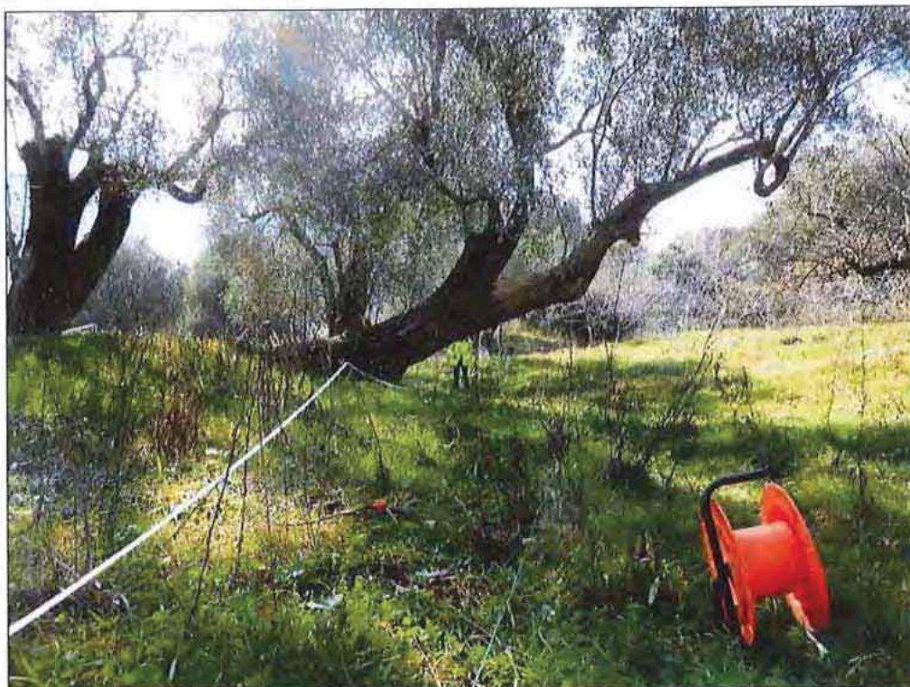
Foto 1: Profilo sismico a rifrazione R1 con 24 geofoni a frequenza di 4.5 Hz
