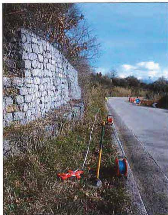
Foto 5: Profilo sismico a rifrazione R5 e MASW M2 con 24 geofoni a frequenza di 4.5 Hz
