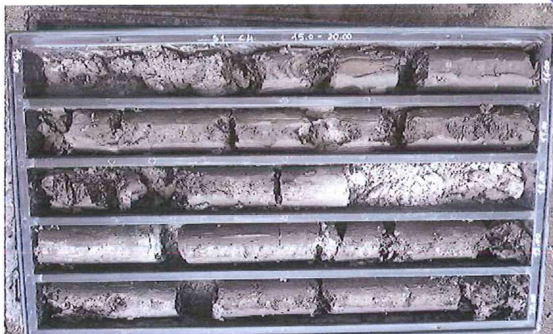
Sondaggio S1 – Cassetta C4 – da 15,00 a 20,00 m di profondità dal p.c.
