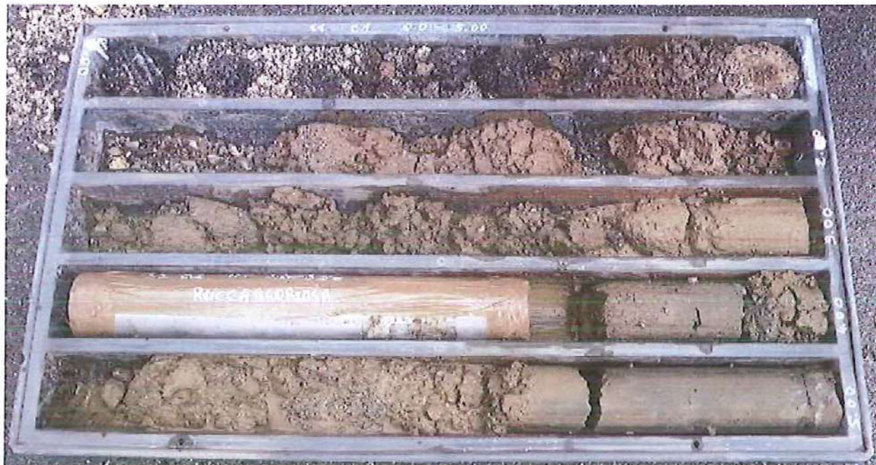
Sondaggio S1 – Cassetta C1 – da 0,00 a 5,00 m di profondità dal p.c.
