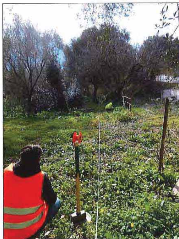
Foto 3: Profilo sismico a rifrazione R3 con 24 geofoni a frequenza di 4.5 Hz
