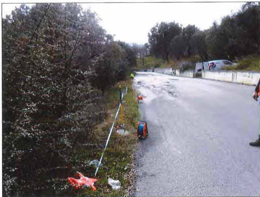
Foto 2: Profilo sismico a rifrazione R2 e MASW M1 con 24 geofoni a frequenza di 4.5 Hz
