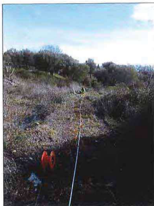
Foto 6: Profilo sismico a rifrazione R6 con 24 geofoni a frequenza di 4.5 Hz
