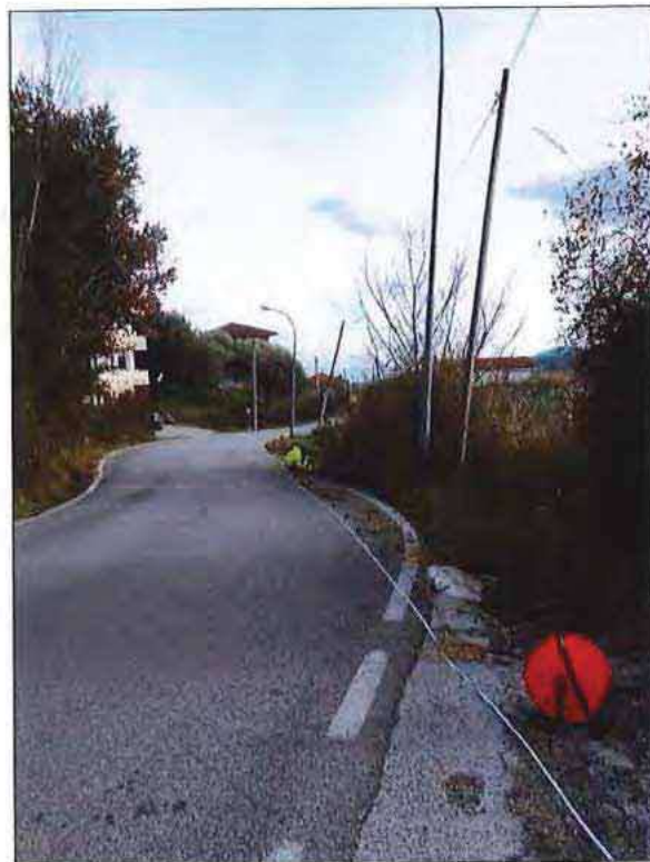
Foto 7: Profilo sismico a rifrazione R7 con 24 geofoni a frequenza di 4.5 Hz
